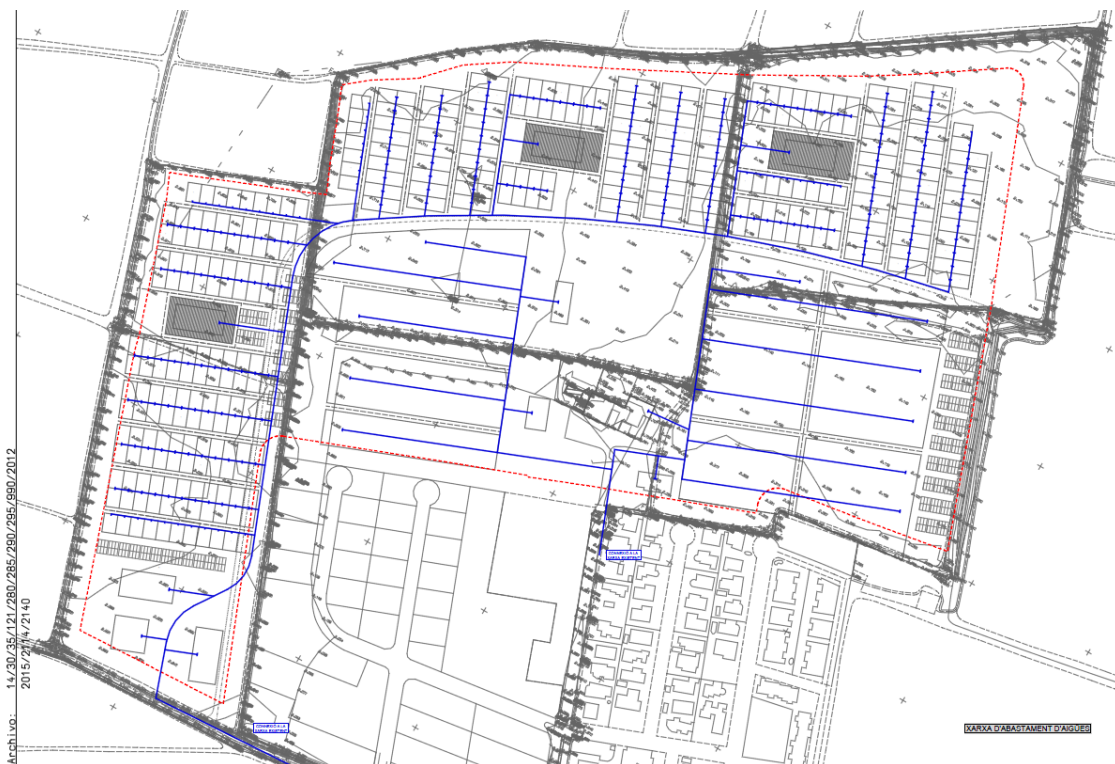
Figura 38. Infraestructura prevista per a l'abastament d'aigua a l'àmbit del Pla. Font: Pla especial urbanístic càmping Masnou, 2021.
