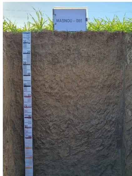
Fotografia 1. Perfil MASNOU-005. Seqüència d'horitzons Ap-Bw1-Bw2-Bw3.
