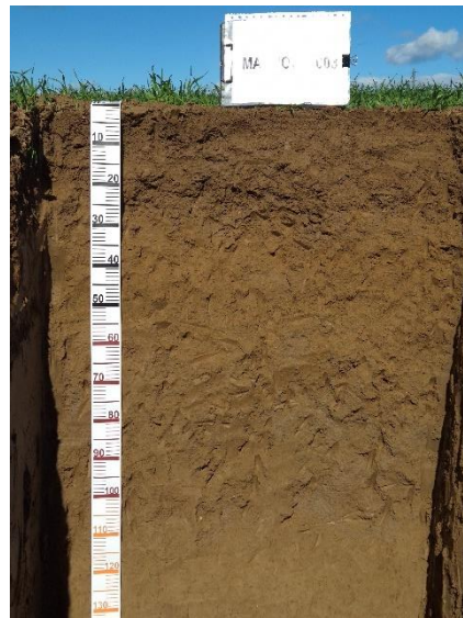
Fotografia 1. Perfil MASNOU-003. Seqüència d'horitzons Ap-Bw1-Bw2-Bw3.
