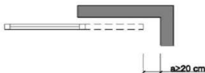
Figura 2.1 Holgura para evitar atrapamientos
